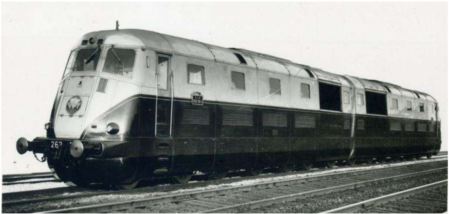
PLM 262 BD1 (3 baie frontales), semi carénage, avec nonogramme PLM et plaques PLM, env. 1938, (notre Art.no.: 2265/2)
